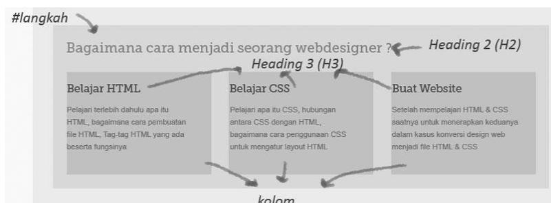
Gambar 97 Layout Kolom untuk bagian #Langkah
